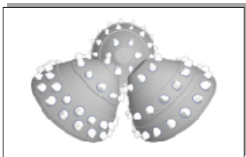
掘削用超硬ビット設計例 3Dシミュレーションによる確認
