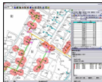
水道GISによる断水検索の画面サンプル
