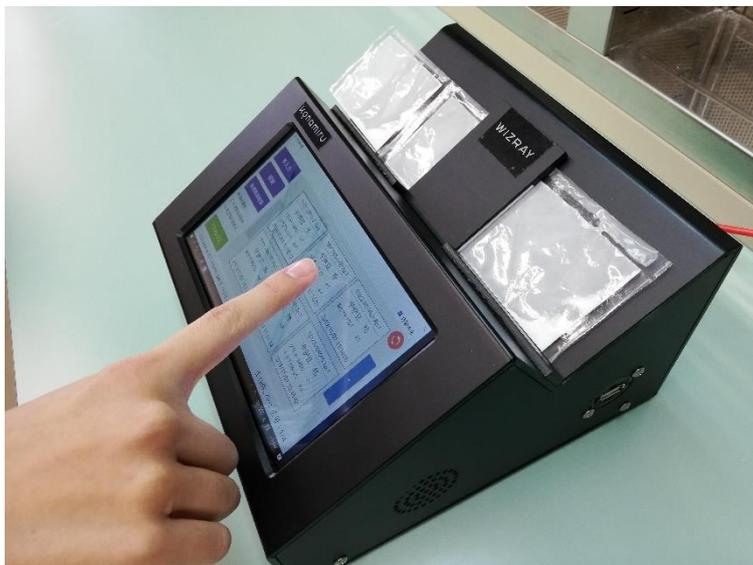
第一弾の製品として、薬剤師が調剤し一包化した粉薬が処方箋通りの内容になっているかどうかを、近赤外分光法を用いて瞬時に判別する散薬監査支援装置「コナミル」の試作機を完成させています。すでに県内の病院・薬局のご協力のもと「コナミル」のテスト運用が終了し、ここで得られた測定データや薬剤師の声をもとに、大手調剤機器メーカーと協力しながら最終製品へと改良を重ねているところです。「コナミル」の年内の発売を目指すとともに、第二弾、第三弾製品の研究開発も進めています。
