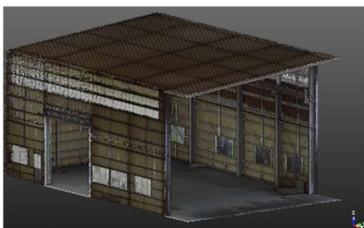
このようなデータを3D-CADなどのソフトウェアに読み込み、その後の工事、製造に活用するための3Dモデルや2D図面の作成までを行う取り組みを行っています。
