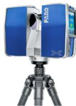
地形や構造物などの対象物に複数に変調させたレーザー（クラス1レーザー）を照射し、X、Y、Zの3次元座標データを取得します。この取得したデータを編集して、土木工事やプラント改修工事等に活用する3次元データを作成していきます。（図1、図2参照）
