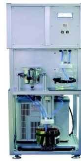
自動溶媒洗浄 ・溶媒再生装置
