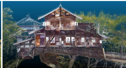
（図5）備中松山城の点群データ。城内、石垣や地形をほぼそのままの寸法で記録している。
