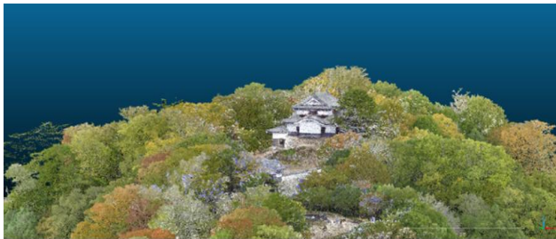
（図5）備中松山城の点群データ。城内、石垣や地形をほぼそのままの寸法で記録している。
